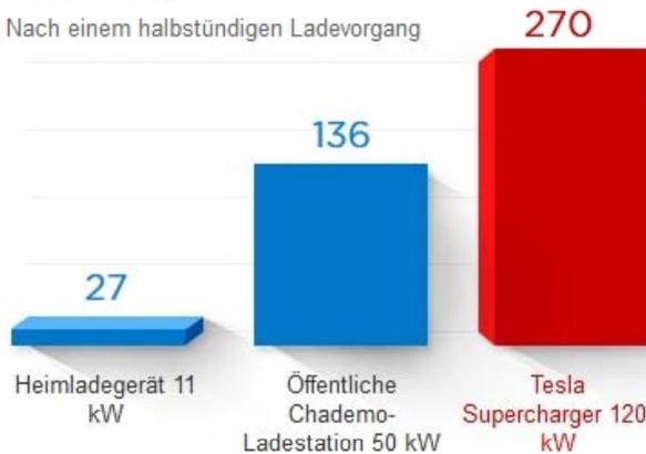
Die Tesla Supercharger liefern in 30 kurzen Minuten ca. 270 km Reichweite.
