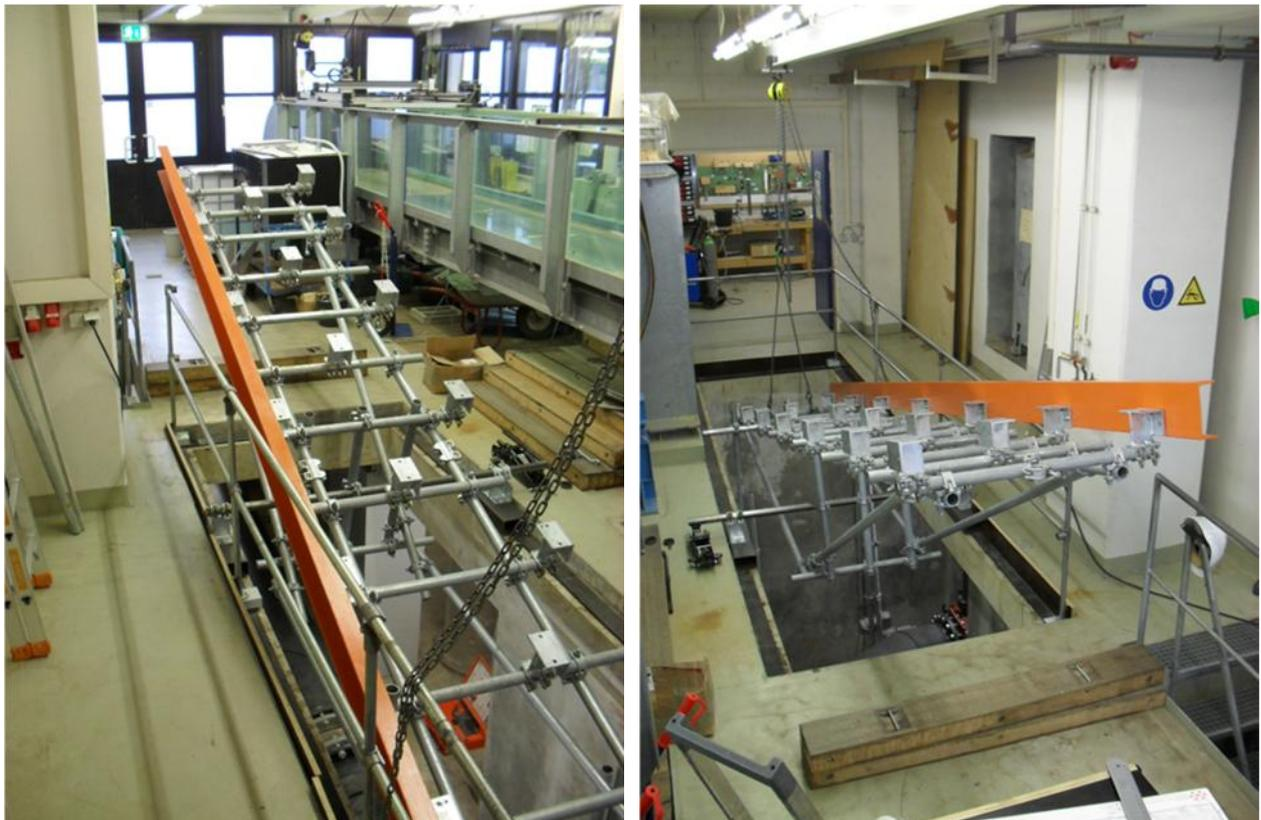
Abbildung 10: Versuchseinrichtung zur Überprüfung und Anpassung der Fließformeln zur Simulation des Oberflächenabflusses an steilen Hängen (Baufortschritt September 2016)
