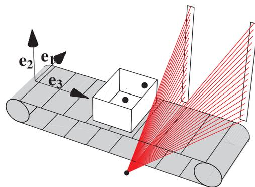
Abb. 4: Detektionsanlage zur Gepäckkontrolle (schematisch)
