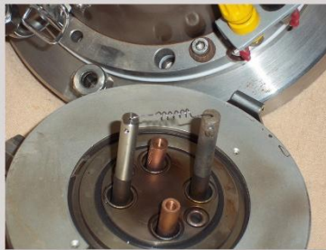
Erzeugung von Argon-Ionen für die Oberflächen-Analytik in der Sekundär-Ionen-Massen-Spektroskopie (SIMS)
