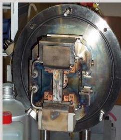
Erzeugung schwerer Ionen für die Grundlagenforschung in einer Hohlkathoden-Quelle
