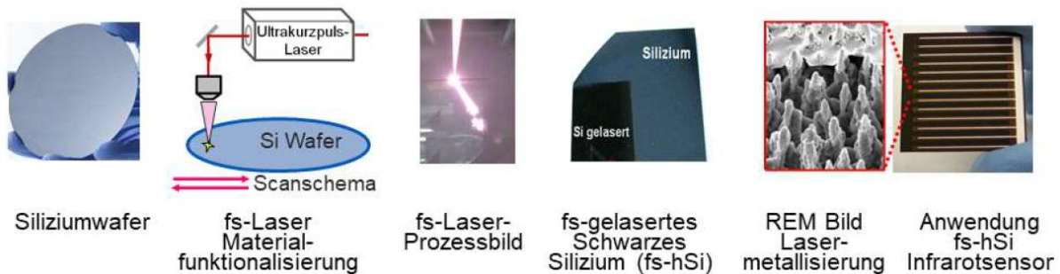
Abbildung 4.6.1: Photonische Wertschöpfungskette I: Vom Ausgangsmaterial bis zur Anwendung, hier am Beispiel des Halbleiters Silizium, der mit einem fs-Laserprozess zum Funktionswerkstoff "fs-hSi" veredelt wird und als IR-Sensor Anwendung findet.
