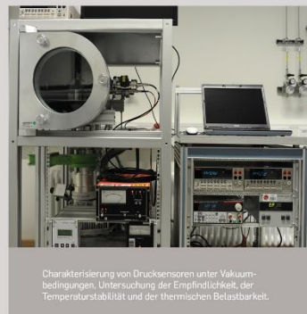
Untersuchung der physikalischen Kenngrößen von dünnen Schichten aus Metall oder Halbleiter unter Vakuumbedingungen:
