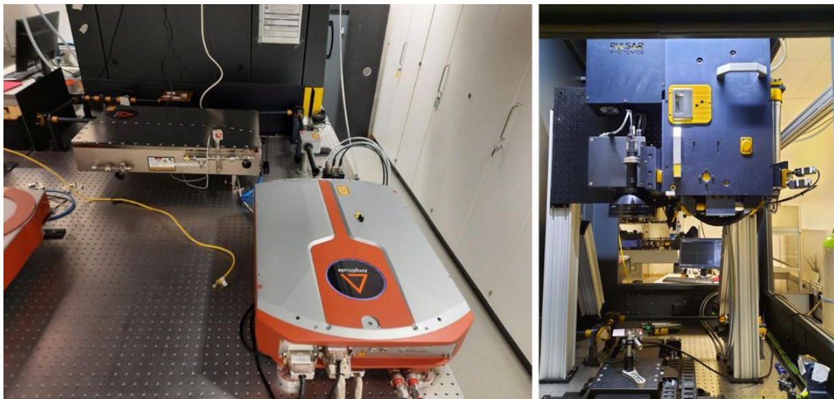
Abbildung 3.3.1: Links: Hochleistungs-fs-Lasersystem mit Kompressionsmodul. Rechts: Scansystem mit integriertem Strahlformmodul
