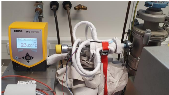
Abb. 4.1.2: Messaufbau zum Temperieren der Kupferschaum-Proberöhrchen (links). Exemplarisches Spektrum, gemessen mit dem 30 ppi Kupferschaum bei Lufteinlass (rechts).
