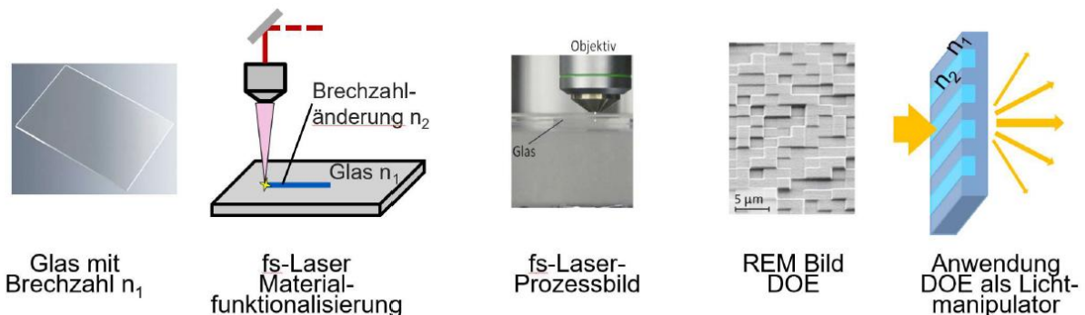
Abbildung 4.6.2: Photonische Wertschöpfungskette B: Vom Ausgangsmaterial bis zur Anwendung, hier am Beispiel von Quarzglas, das mit einem fs-Laserprozess zu einem Phasen-DOE 2 veredelt wird und als lichtlenkendes Element Anwendung findet.
