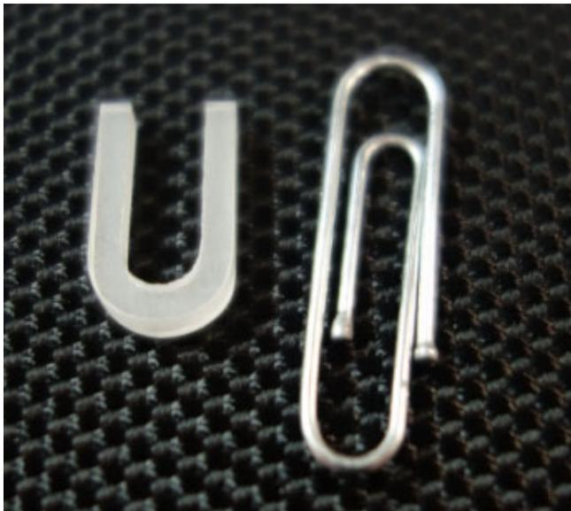
**Bild 28:** Ein Zirconia-U mit Querschnittsfläche  $2\text{mm} \times 2\text{mm}$
