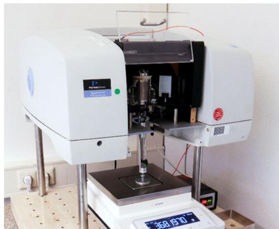
**Bild 21c:** Spektrometer mit eingebauter Messküvette und Präzisionswaage
