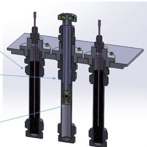
**Bild 23a:** Tank-Sensor-Kombination zum Eintauchen in ein temperiertes Ölbad
