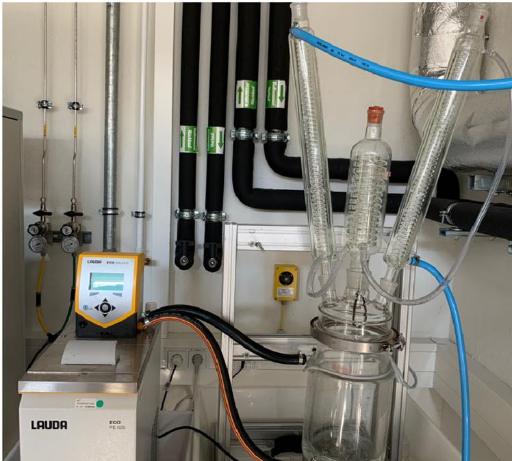
**Bild 18:** Ätzstation für das anisotrope Ätzen von 4-Zoll-Siliziumwafern mit präzise definierter Ätzbad-Temperatur und -Zusammensetzung
