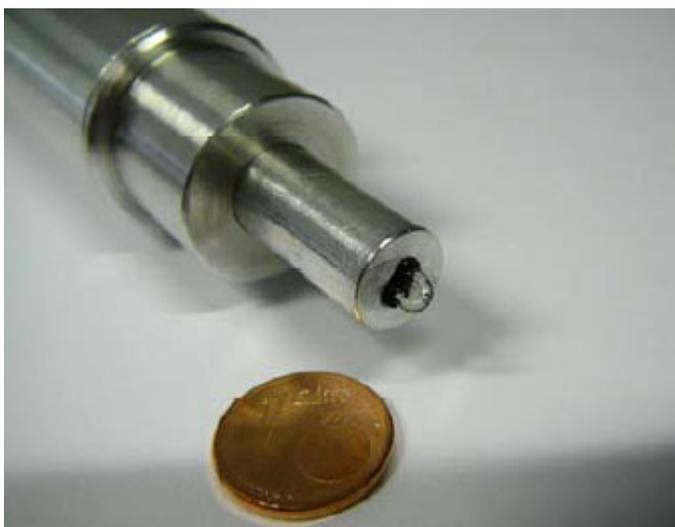
**Bild 26:** Sensorkopf mit entmantelter Polymerfaser, als U gebogen
