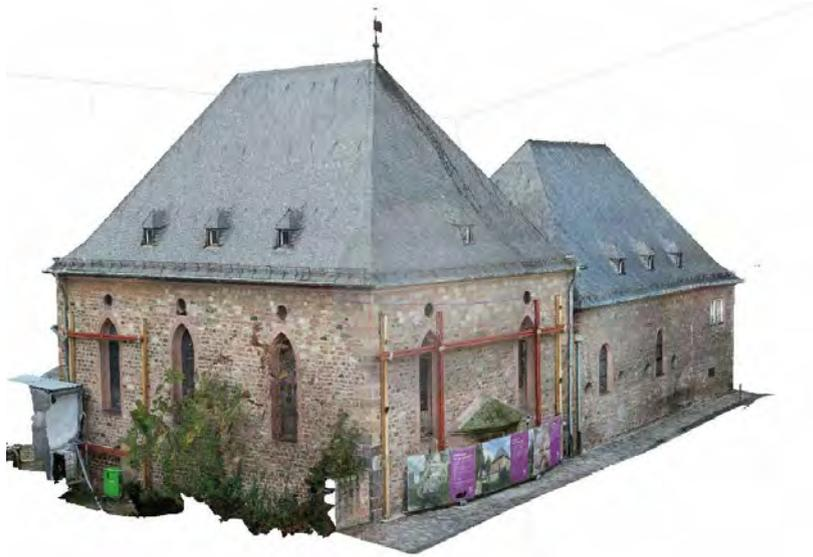
**Dreidimensionales, texturiertes SfM-Modell (Structure from Motion), aufgebaut aus einer digitalen Punktwolke und einer großen Anzahl von Einzelfotos.**
