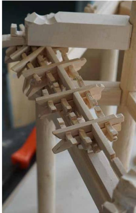
**Modellbau in der Holzwerkstatt. Die feinen Einzelteile wurden mit Japansäge, Stechbeitel, Schnitzmesser und Feilen aus Lindenholz gefertigt.**
